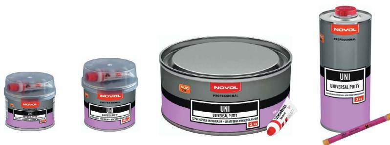
C'est un mastic de remplissage de base. Relativement dur et peu flexible, il est recommandé principalement pour le traitement mécanique et pour des surfaces qui ne sont pas très grandes. Il possède une bonne adhérence sur différents substrats. Son utilisation n'est pas recommandée sur l'acier galvanisé de zinc.
